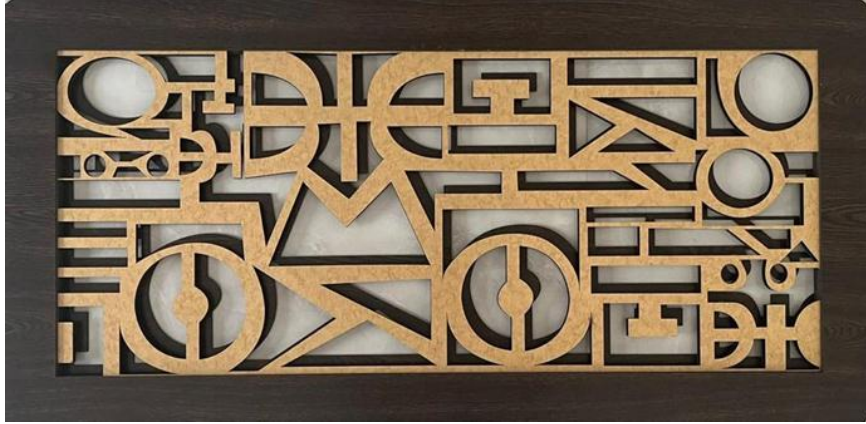
شكل (10) تجربة الباحثة، تقنية القص الليزري، خامة الخشب، جهاز القطع بالليزر Laser Cutting Machine موديل: AS-1380 رقمه: AS966C138912041858، نوع الليزر ثاني أكسيد الكربون، مقاس 60 × 150 سم.
