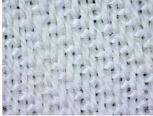
صورة للعينة رقم (8) والتي حققت أعلى معامل جودة للتركيب والمنتجة بالتركيب النسجي (مبرد 2/2) عند تثبيت الخامة بامبو 100%
