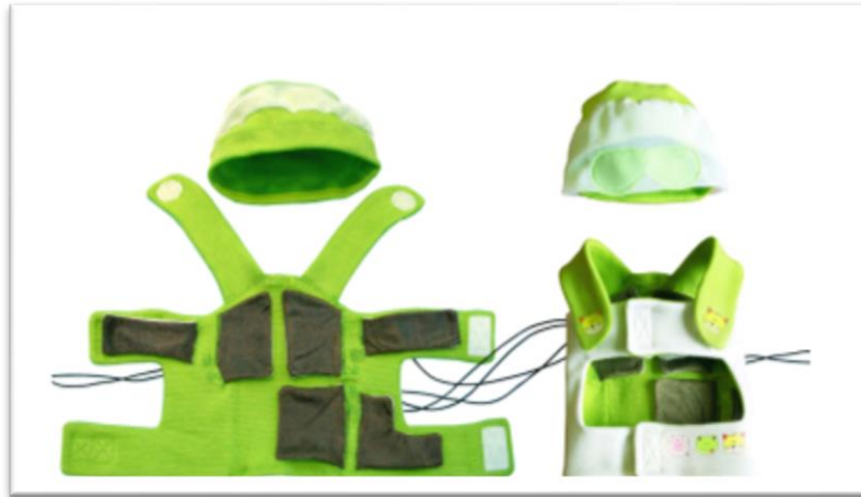
صورة (2) سترة ذكية بها حساسات إلكترونية لمراقبة الوضع الصحي للأطفال حديثي الولادة (Bouwstra, S., et al, 2009, P.166)
