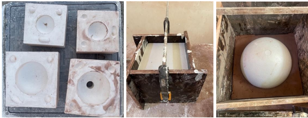
الشكل (11) عملية صناعة القوالب الجبسية
