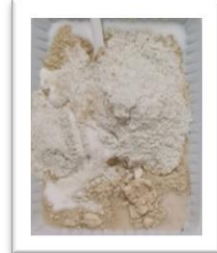
شكل رقم (23) يوضح مرحلة خلط مادة الترا فلور بالماء بنسبه قليلة لتكون متماسكه
